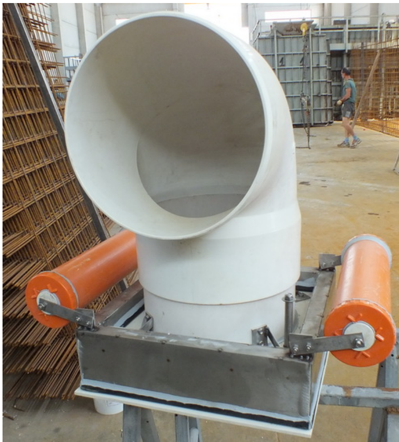
Valvola di chiusura automatica a galleggiante
